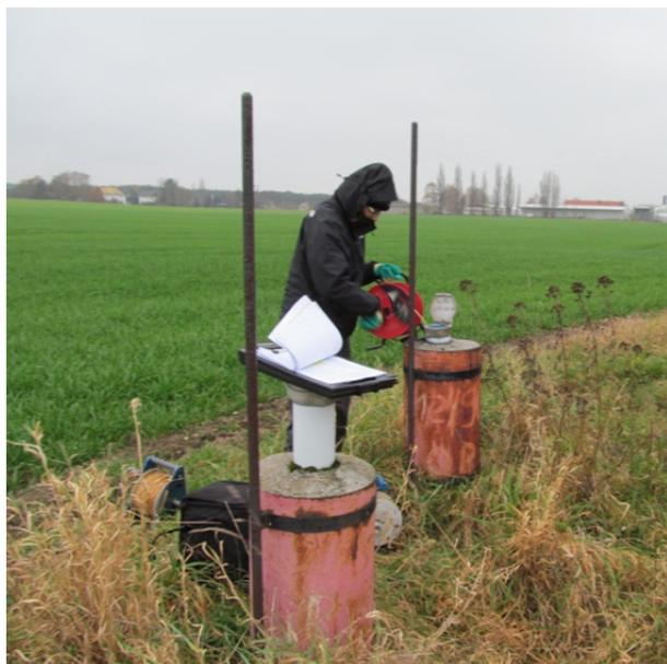
**Stichtagsmessungen und Grundwasserprobenahme**
