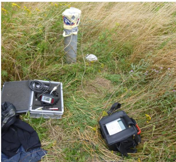
**Ausrüstung zur Bodenluftprobenahme**
