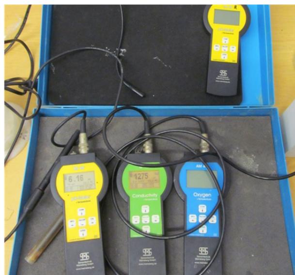
**Ein Messgerätesatz zur Erfassung der Vor-Ort-Parameter bei der Probenahme von Trink-/Grund- und Oberflächenwasser**
